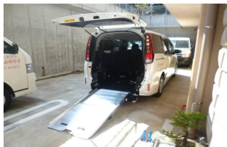
スロープ起動写真
